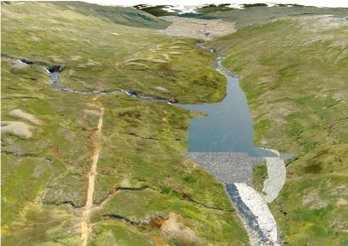
MYND 3.4 Inntakslón og stífluvalkostur I við Innri-Lambadalsá. Stífla einfölduð og eingöngu til viðmiðunar. Núverandi vegslóði upp dalinn er til vinstri á myndinni.
